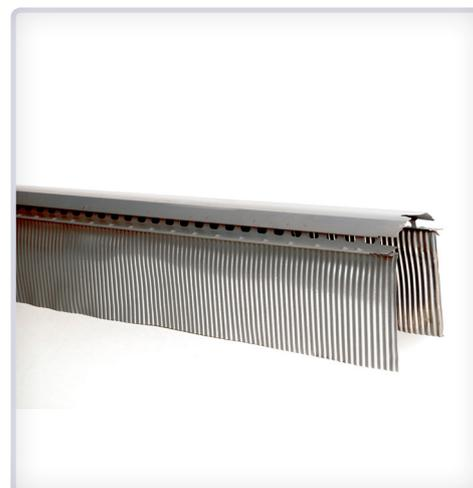
HB-VentPiombo assure la ventilation de la ligne de comble. On le pose à sec. La taille de 90 mm est idéale pour des tuiles marseillaises et plates, 140 mm pour des tuiles plus ondulées comme les tuiles hollandaises et portugaises et les tuiles canal, 175 mm de façon spécifique pour les toitures en tuiles canal.
