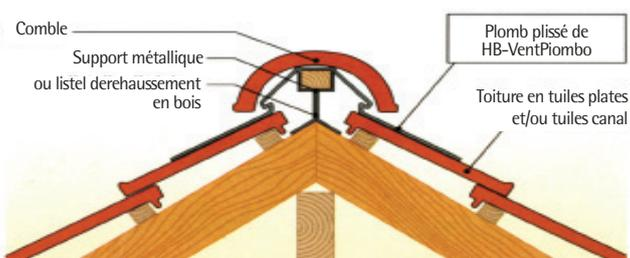
HB-VentPiombo doit être fixé de chaque côté avec des clous ou des vis sur le listel de bois soutenu par le support métallique
