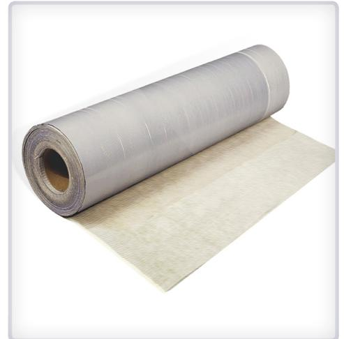
Softsound 2 est le matelas d'insonorisation de Harobau qui introduit un effet acoustique architectural positif. Désaccouplant et flexible, il réduit la tension et il est très résistant à la pression de l'eau. Il a un index de limitation du piétinement sous des carreaux et du lamellé-collé de 17 dB et il est soumis à des tests conformément à la norme DIN EN ISO 140-8
