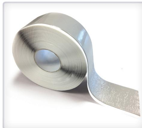
Nastro butilico impermeabilizzante estensibile, costituito da un compound in gomma di butile autoadesiva sigillante e autoprotetto con un film LDPE da 30 micron.
