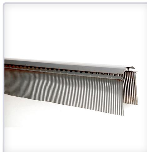
HB-VentPiombo assicura la ventilazione della linea di colmo. Viene posato a secco. La misura 90 mm è ideale per tegole Marsigliesi e piane, 140 mm per tegole più ondulate come Olandesi e Portoghesi e coppi, 175 mm specificatamente per coperture in coppi.
