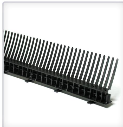
Pettine per garantire la ventilazione del tetto, impedendo anche ai piccoli volatili di insediarsi e edificarvi sotto la copertura provocando problemi di infiltrazione.
