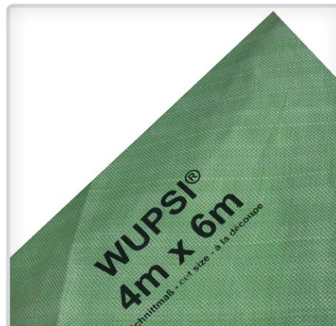
Teloni universali di protezione e copertura, in PE-tessuto rinforzato da 220 gr/m<sup>2</sup>; bordi rinforzati; resistenza allo strappo 1.000 N; occhielli in alluminio lungo tutti i bordi a distanza di 50 cm, traslucente; resistenza massima ai raggi UV, idonei per l'utilizzo di lunga durata, non degradabile.
