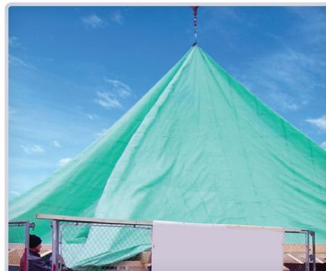
In PE-tessuto rinforzato da 200 gr/m<sup>2</sup>; bordi rinforzati di ca. 5 cm; resistenza allo strappo 1.000 N (tessuto), occhielli in alluminio lungo tutti i bordi a distanza di 100 cm, traslucente, resistenza massima ai raggi UV, non degradabile.
