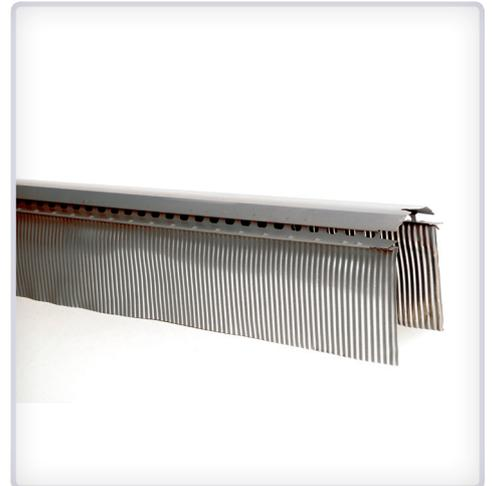
HB-VentPiombo gewährleistet die Lüftung der Firstlinie. Das Produkt wird trocken verlegt. Das Maß 90 mm ist ideal für Marseille- und Flachdachziegel, das Maß 140 mm für stärker gewellte Dachziegel wie Holländische und Portugiesische Pfannen und Hohlziegel, das Maß 175 mm spezifisch für Hohlziegeldächer.
