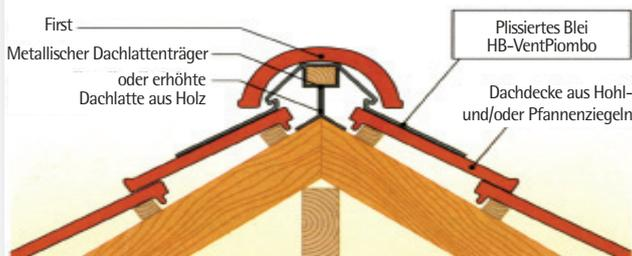
HB-VentPiombo muss an beiden Enden mit Nägeln oder Schrauben an der auf dem metallischen Dachlattenträger aufliegenden Holzlatte befestigt werden.
