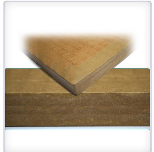
Phonewell ist eine Platte zur Trittschalldämmung (Tritt- und Luftgeräusche). Die Platte hat eine Struktur aus überkreuzten und verklebten Kartonschichten, die mit reinem, gebranntem Quarzsand gefüllt ist, d.h. mit einer schweren, losen Masse. Nur eine solche Masse, verbunden mit leichten Füllmaterialien, kann eine so hohe Schalldämmung gewährleisten. Diese patentierte Kombination ist der Schlüssel für einen bisher undenkbaren Wohnkomfort.
