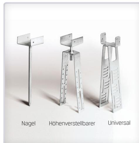
Dachlattenhalter können in drei verschiedenen Modellen geliefert werden: Nagel- Dachlattenhalter, Universal-Dachlattenhalter, Höhenverstellbare Dachlattenhalter. Sie gestatten die Befestigung der Holzlatte, die den Firstlüfter trägt. Der Dachlattenhalter wird direkt an der Firstlinie befestigt. Die Öffnungen des Dachlattenhalters gestatten die Einstellung der gewünschten Höhe.
