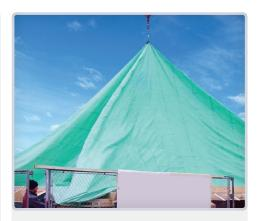
Aus verstärktem PE-Gewebe 200 gr/m²; verstärkte, etwa 5 cm breite Kanten, reißfest bis 1.000 N (Gewebe), Aluminiumösen an allen Kanten im Abstand von 100 cm, durchscheinend, maximale UV-Beständigkeit, verwitterungsfest. Gestattet durch Einhängen am Kran ein rasches Abdecken des Dachs bei Regen. Sehr reißfest, praktisch, leicht auszubreiten. Die Plane ist lichtdurchlässig, so dass auch unter der Plane weitergearbeitet werden kann.
